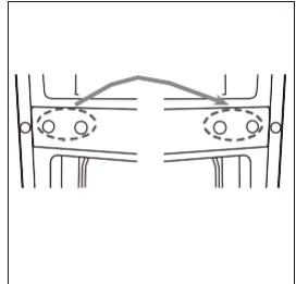
9. Отвинтите нижний шарнир. Затем снимите регулировочные ножки с обеих сторон.
