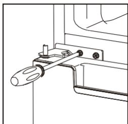
15. Замените верхнюю дверь, убедитесь, что дверь выровнена со шкафом, чтобы уплотнитель двери плотно прилегал к шкафу. Затем соедините дверь со шкафом, плотно зафиксировав верхнюю петлю.
