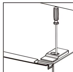
7. Снимите верхнюю дверцу, крестовой отверткой выньте винт из средней петли, затем снимите нижнюю дверцу.
