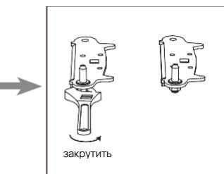
11. Установите на место кронштейн, подходящий к штифту нижней петли. Установите на место обе регулировочные ножки.
